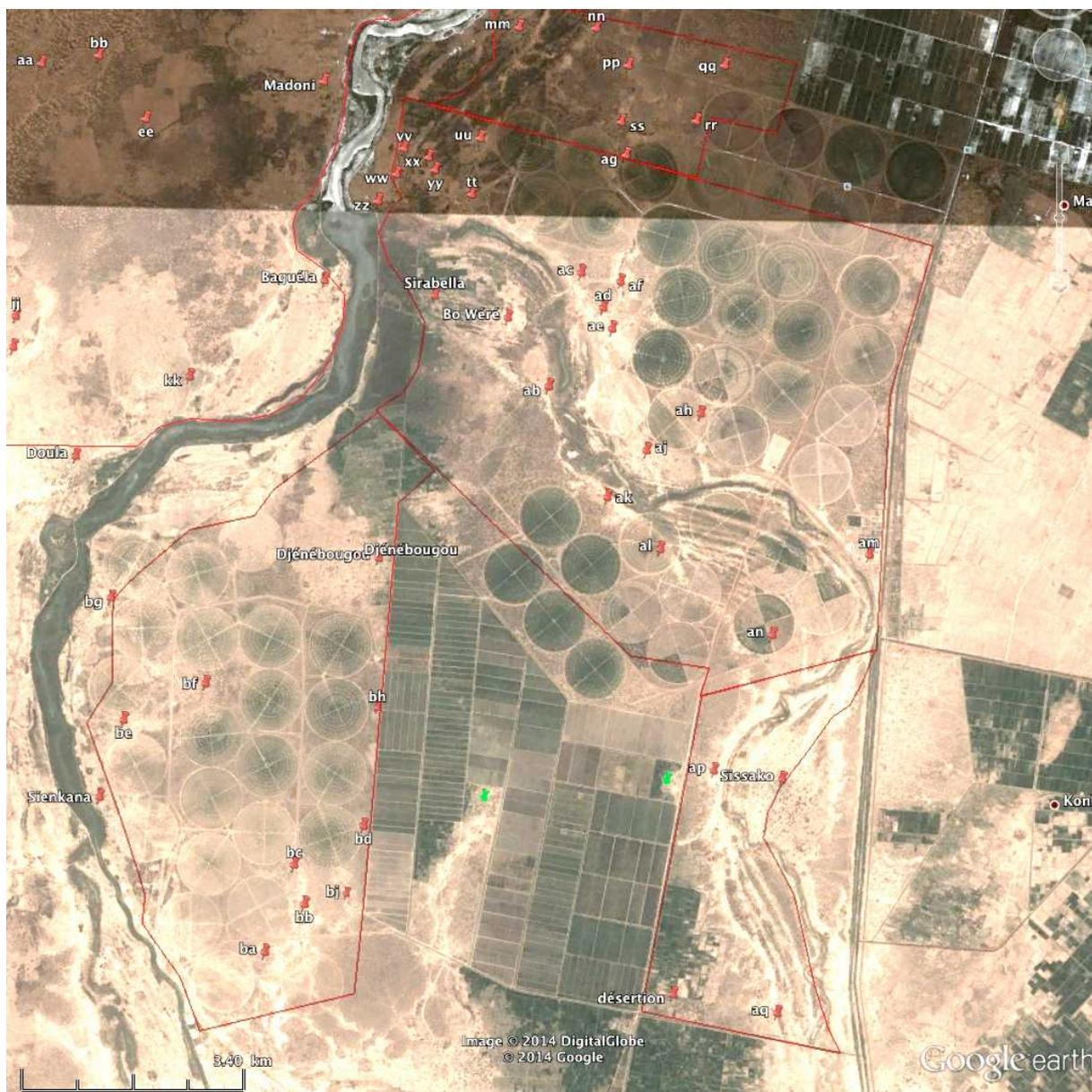
Installation de 63 pivots d'irrigation circulaires dans les concessions n° 2, 3 et 4 de *N'Sukala*, dans le delta du Niger. Les lettres et les signets indiquent les villages et hameaux pré-existants. Capture de *Google Earth*.
